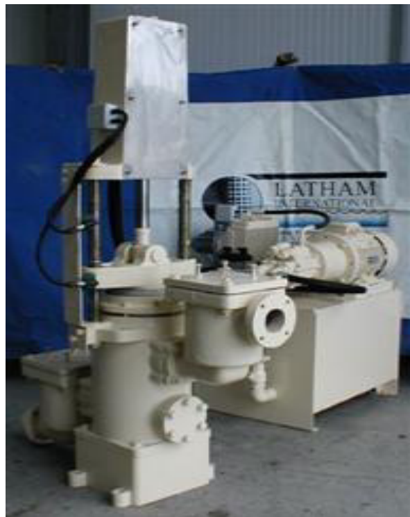
Pistón de la bomba reformado
