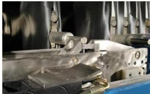
Mecanismo de Movimiento de la Placa con Dispositivo Sacudidor para ayudar a la descarga de la torta.
