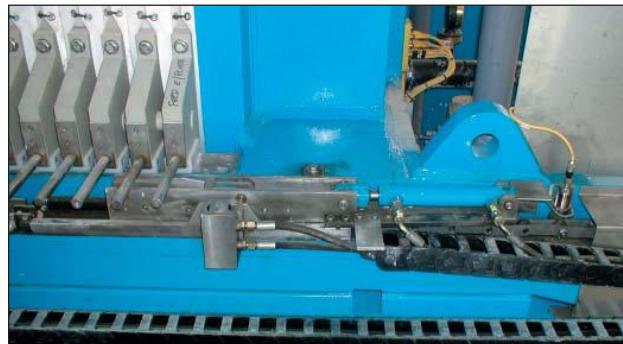
**Механическая каретка с устройством разрыва плит и устройством встряхивания** (I – пакет нераэгруженных плит, II – разгруженные плиты, III – зона зацепления плиты, IV – зона разрыва, А – движение каретки к опорной плите, В – движение каретки к головной плите, С – рычаг-ограничитель, D – рычаг зацепления, Е – гидроцилиндр встряски плит, F – отрывающий гидроцилиндр, G – гидроцилиндр фиксатор).
