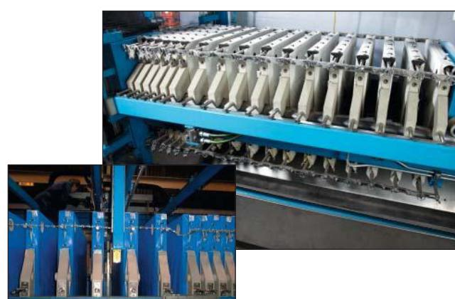
**Фиксированная система мультивстряски пакета плит.** (С – балка, D – гидроцилиндры встряски).
